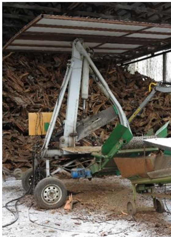
Figur 6: Med Hakkarainens stora hydrauliska kniv skärs stubbarna i småbitar.
