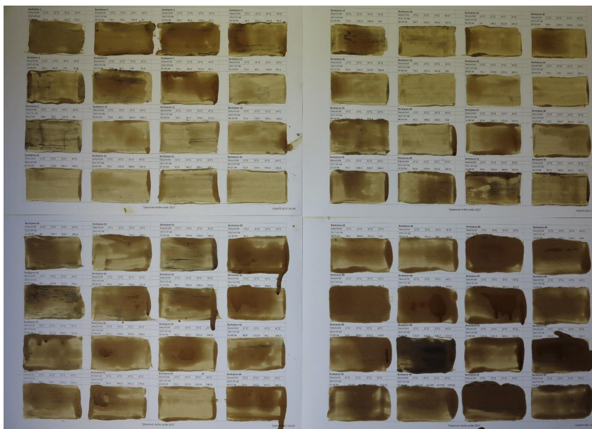
Figur 27: Urval av uppstrykningsprov på papper med prover från Ardre såide. Notera färgnyansen som går från lust till mörkare allt som bränningen fortskrider.
