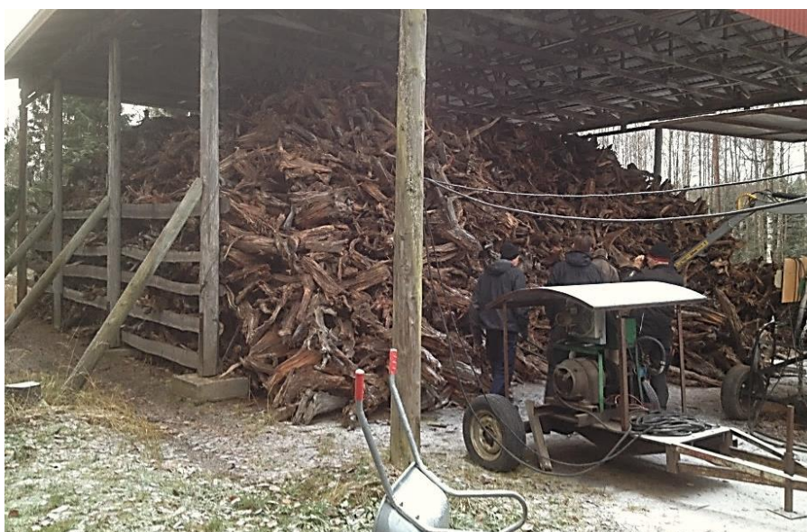
Figur 7: Topis tjärstubbar får torka i 6 år i ett luftigt lager innan de bränns.
