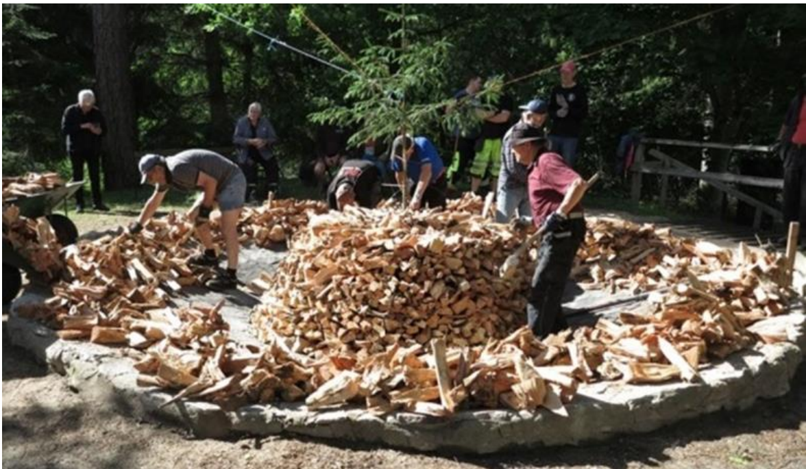
Figur 17: Ardre såide under stapling. Notera träklubban som används till att packa stacken.
