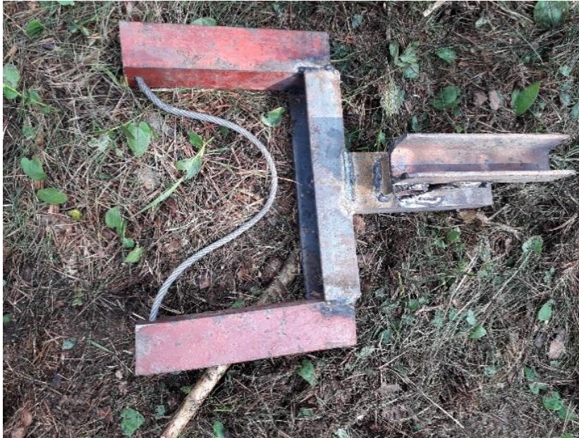
Figur 27 Närbild på egentillverkat verktyg för barkning/katning med klyka och vajer.
