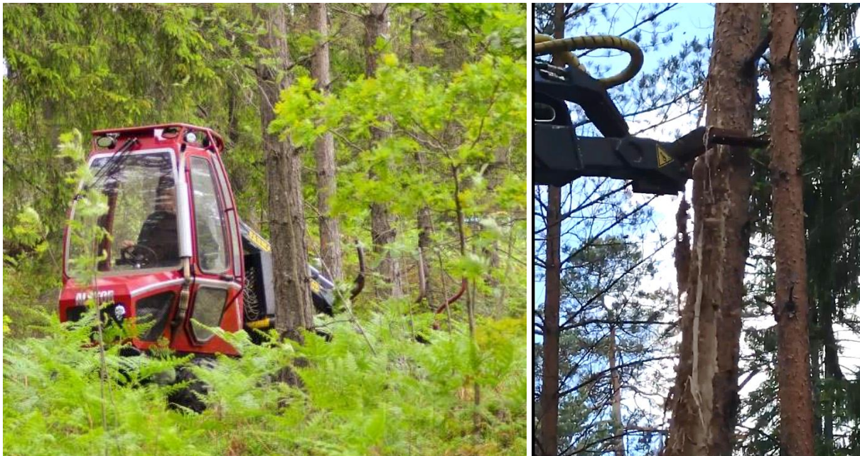
Figur 28: Alstor miniskotare. Foto Monika Syversen. Figur 29: Bild till höger, försök att kata med vajer. Foto Monika Syversen
