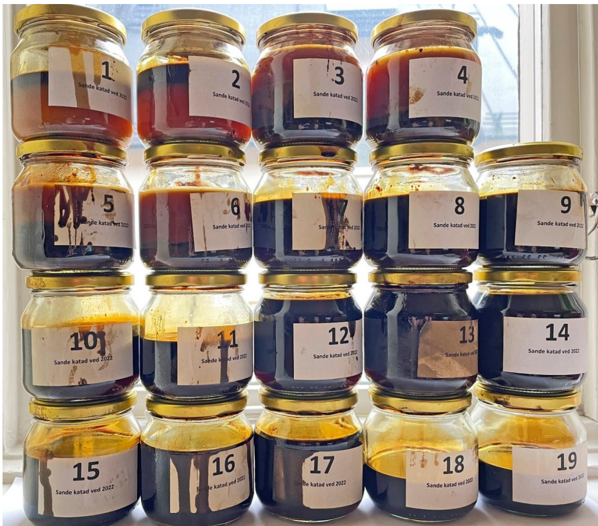
Figur 15: Burkar med tjärprover från Sande tjärdal. Burk 1-6 innehåller stor andel tjärvatten (synligt som ett ljusare lager) och en mindre mängd tjärvatten finns också i burk 12-15. Notera att tjärvattnet flyter ovanpå tjäran i burk 3-6. Med andra ord, i dessa prov är tjäran tyngre än vattnet. I övriga burkar är det ett omvänt förhållande.
