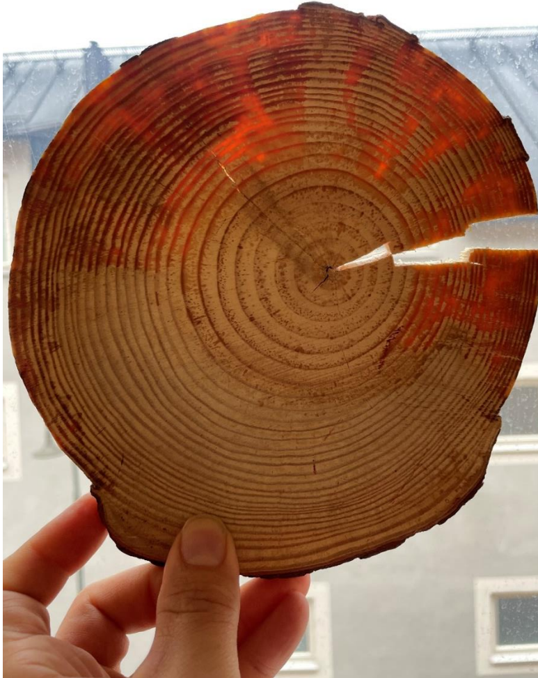
Figur 30: Katad stam i genomskärning i torkat tillstånd. De mörkare partierna är områden med hartsbildning. Provbitten är tagen ur ett av de träd som stått längst, 3½ år. Notera också att det blir sämre hartsbildning om man inte lyckas få bort även innerbarken. I bildens nedkant kan man se den sparade barkranden mot norr och att man i detta område inte får någon hartsbildning alls.
