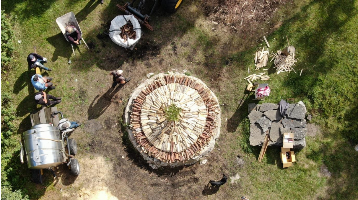
Figur 9: Tjördalen fotograferad från ovan i färdigstaplat tillstånd. Den yttersta ringen staplades med vanlig tändved och de övriga ringarna med den katade veden.
