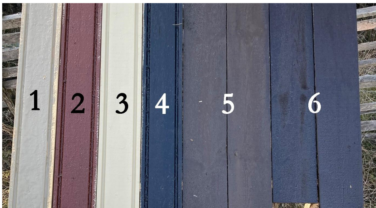
Figur 71: F. v. 1. Zinkvitt + titanoxid. 2. Bränd terra. 3. Titanoxid. 4. Oxidsvart. 5. Guldockra. 6. Oxidbrun. Foto taget i samband med att tjärstrykningen gjordes.
